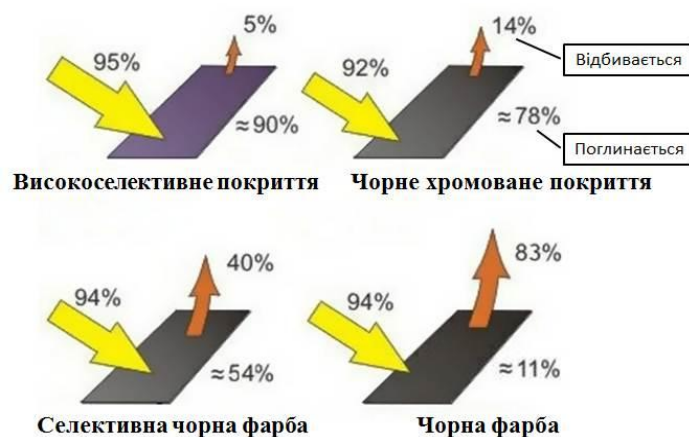
Рис.62. Ефективність поглинання та відбивання сонячного світла покриттями різних видів
