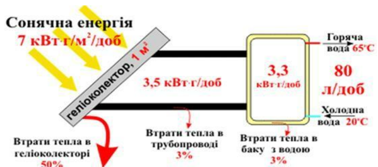
Рис.64. Умовне вироблення теплової енергії для нагрівання води в сонячний день геліосистемою, площею 1 м 2
