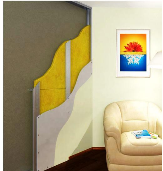
Рис. 26. Внутрішнє утеплення стін
