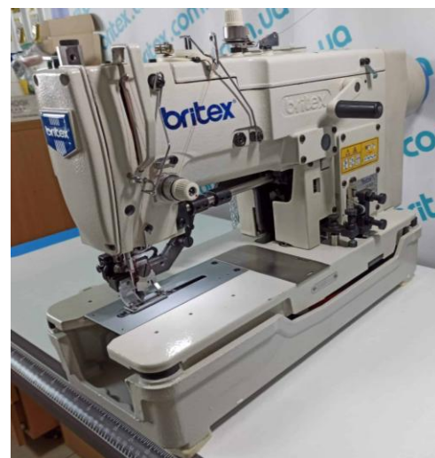
Зовнішній вигляд спеціальної машини (напівавтомату) для виготовлення прямих обметувальних петель
